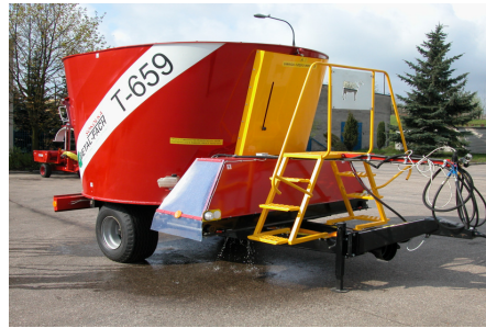
Rys. 4. Widok wozu paszowego (od strony dojścia na pomost obsługowy) „BelMix” T 659 o pojemności zbiornika 11 m 3 , produkowanego przez „METAL – FACH” Spółka z o.o. w Sokółce.
