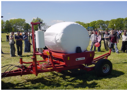
Rys. 3. Widok ogólny owijarki bel Z 577 – po owinięciu beli z podwędniętą zielonką.
